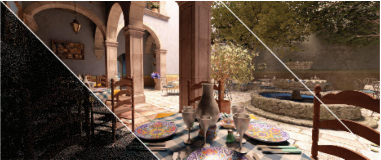
图 11.42：时空方差引导滤波（spatiotemporal variance-guided filtering, SVGF）可以对每像素仅使用一个样本（1spp）的路径追踪图像（左）进行降噪处理，从而创建平滑的无瑕疵图像（中）。其质量与每像素使用了 2048 个样本的参考图像（右）相当。
