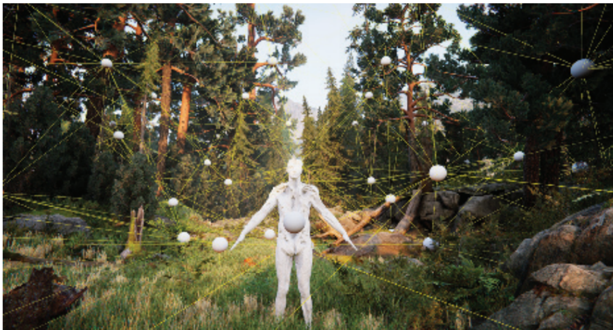
图 11.30：Unity 引擎使用了一个四面体网格，来从一组探针中插值出光照信息。
